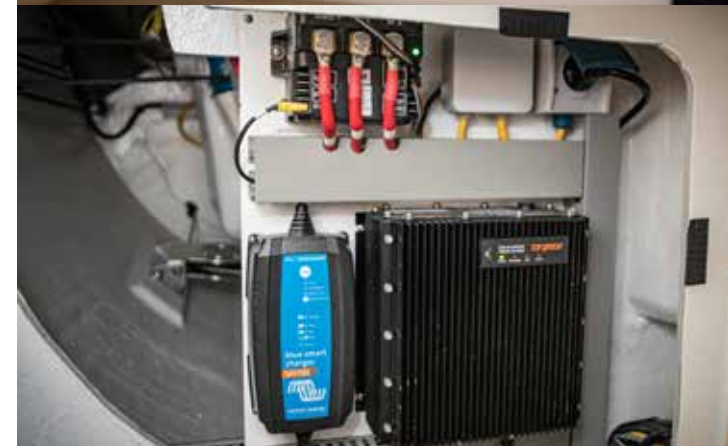
▲ De rompmal van de Se 27 met daarin het testinterieur. ◀▲ Bakboord, achter de hondenkooi. De service-accu is netjes en degelijk vastgezet. ◀ Stuurboord, achter de hondenkooi. Walstroominstallatie en laders zijn degelijk geïnstalleerd.
