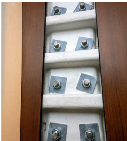
Solide: Eine sehr starke Struktur trägt den Kiel. Die Unterlegscheiben sind abgerundet und entgratet
