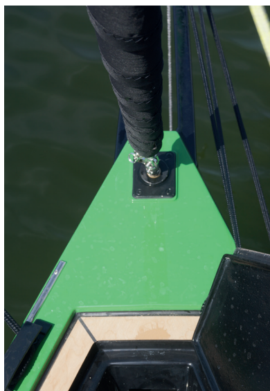
Der Furler des Vorsegels sitzt verborgen unter Deck, dies verbessert Performance und Optik.
