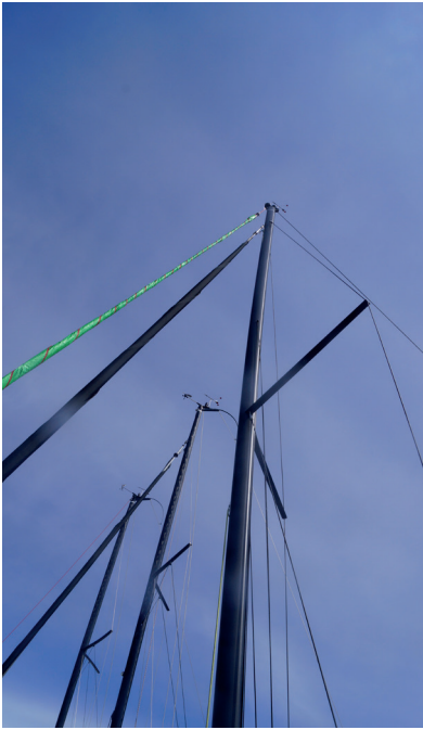
Das Karbonrigg mit PBO-Verstärkung ist ein Extra, im Standard stellt die Werft ein Aluminiumrigg.
