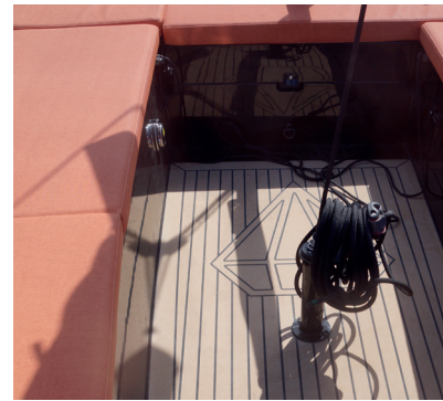
Die Großschot ist auf einem Podest im Cockpit angeschlagen und ausreichend untersetzt.
