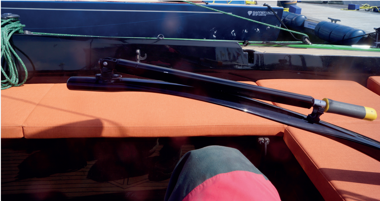
Die Karbonpinne im so genannten Cobra-Design mach nicht nur optisch etwas her, sondern verbessert auch die „Kniefreiheit“. Der Pinnenausleger lässt sich am Süll einklinken und fungiert dann als Feststeller für das Ruder.
